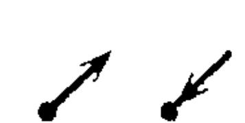
3.1. Проводка уходит на более высокую отметку или приходит с более высокой отметки
