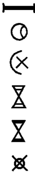
9. Изображения светильников и прожекторов при совмещенном изображении на плане оборудования и электрических сетей приведены в табл. 5.
