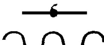
4.16. Проводка гибкая в металлорукаве, гибком вводе
