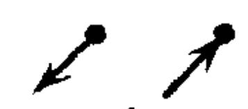
3.2. Проводка уходит на более низкую отметку или приходит с более низкой отметки
