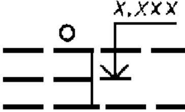
4.7. Проводка в трубе, прокладываемой
