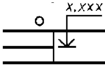
4.10. Проводка в трубе, прокладываемой от отметки трассы вверх
