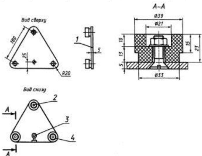
1 — алюминиевая пластина; 2 — винт с шайбой и гайкой; 3 — хомуты; 4 — контактная ножка из проводящей резины
