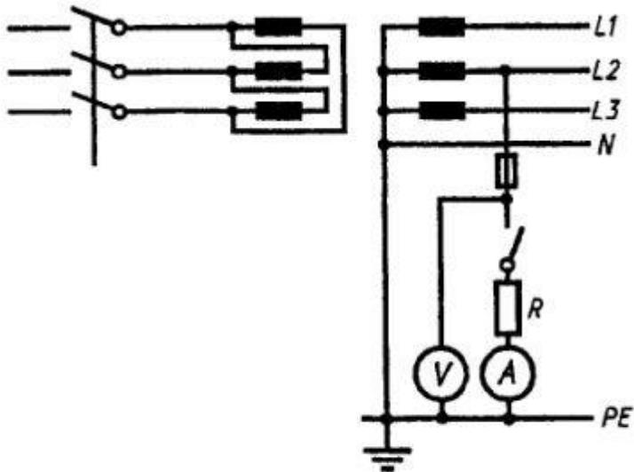
**Рисунок D.1 – Схема измерения по методу 1**
