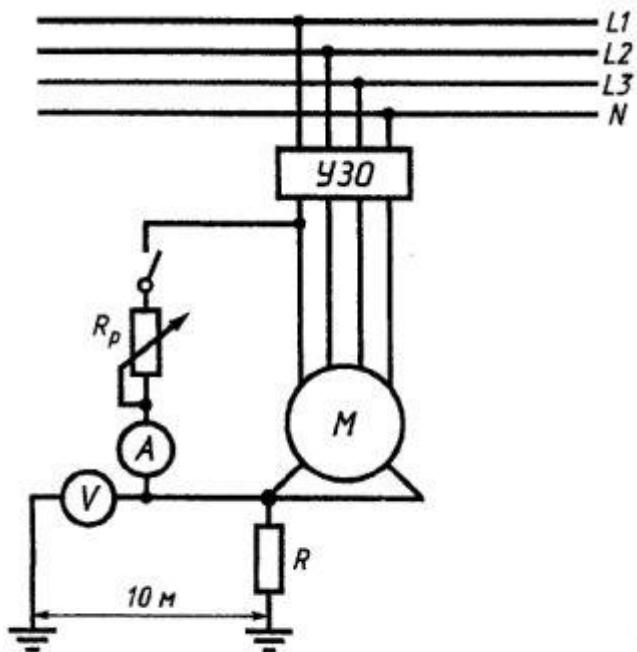
Рисунок В.3 – Схема проверки УЗО по методу 3
