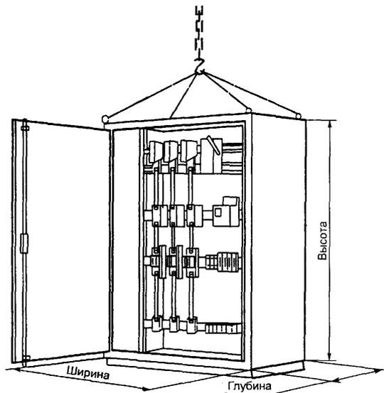
Рисунок С.3 — НКУ заводского изготовления шкафного типа
