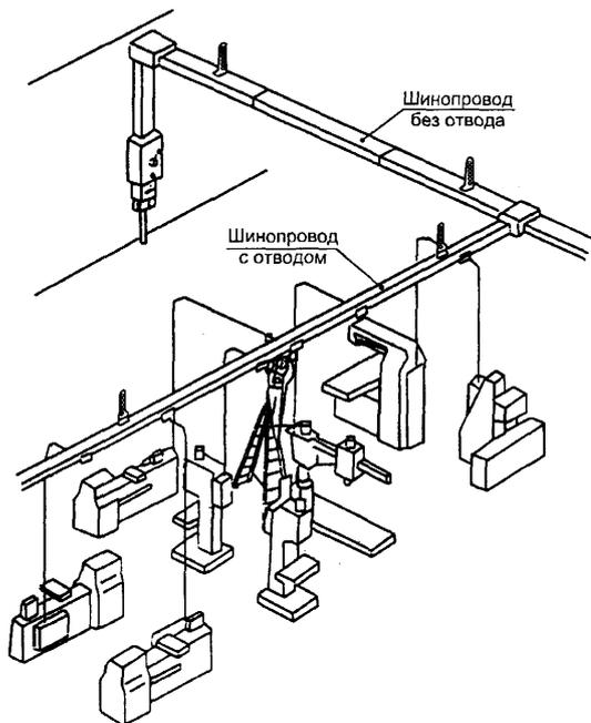
Рисунок С.7 — Система сборных шин (шинопровод)
