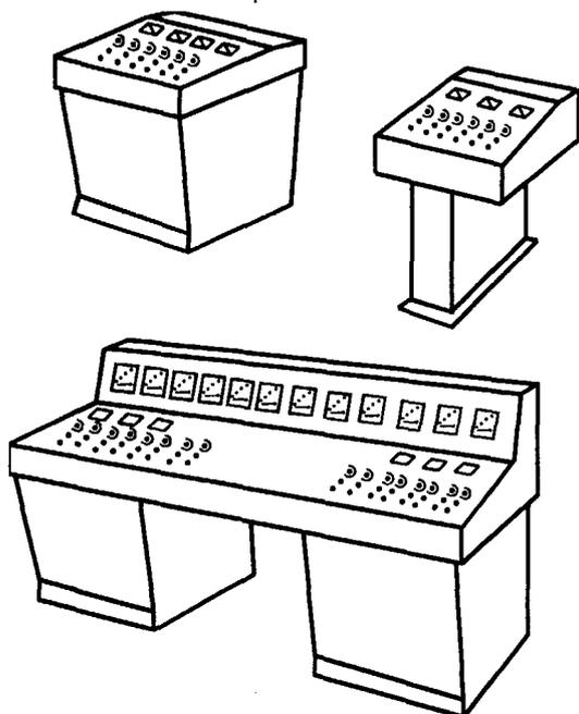
Рисунок С.5 — НКУ заводского изготовления пультового типа
