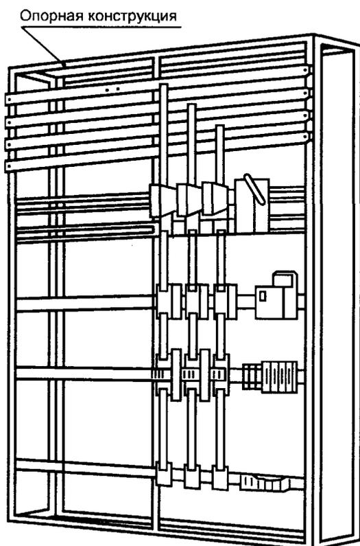
Рисунок С.1 — НСУ заводского изготовления открытого типа
