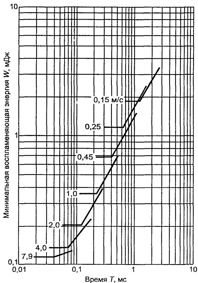
Рисунок A.22. Минимальная воспламеняющая энергия этиленовоздушной смеси (7,3 %  $C_2H_4$  + 92,7 % воздух) в зависимости от длительности разряда и скорости размыкания контактов цепи для подгруппы IIВ
