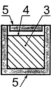
1 - свободная поверхность; 2 - герметизация; половина значения из пункта 3 таблицы 4 при минимальном значении 1 мм; 3 - компонент, герметизирующий материал не должен проникать; 4 - герметизирующий материал, толщина не задана; 5 - металлическая или изоляционная оболочка; для металлической оболочки толщину не указывают, (см. 6.4), для изоляционной оболочки толщина изоляции должна соответствовать значению пункта 4 таблицы 4
