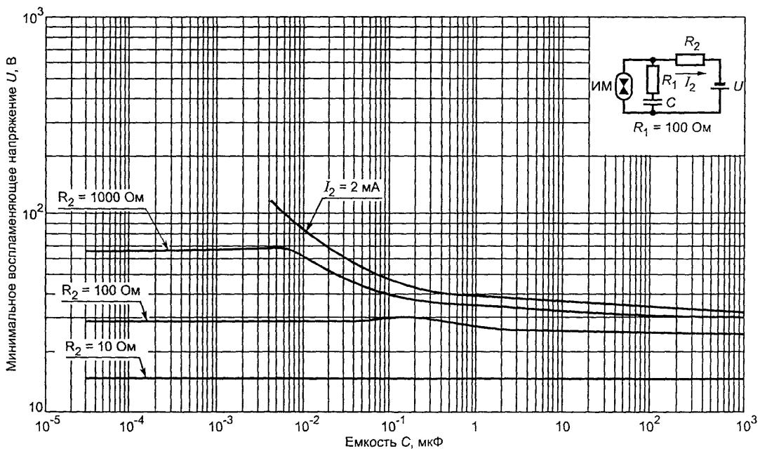
Рисунок А.18. Минимальное воспламеняющее напряжение в активизированной взрывоопасной водородно-кислородной смеси (75 %  $H_2$  + 25 %  $O_2$ ) для емкостных цепей подгруппы ПВ при  $R_1 = 100 \Omega$
