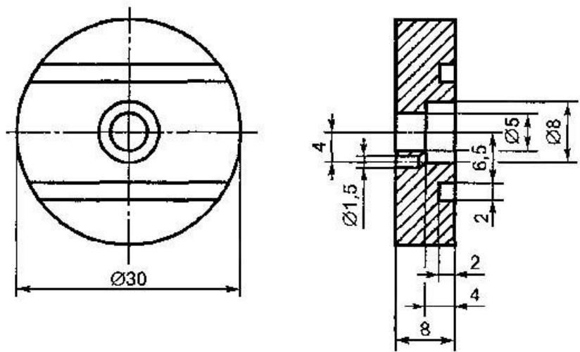
Рисунок Б.2. Кадмийовый контактный диск
