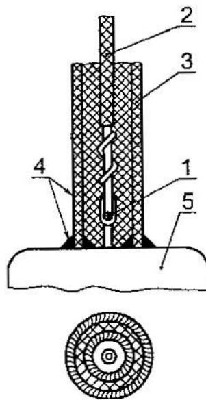
1 - место присоединения провода; 2 - изоляция провода; 3 - изоляционная трубка; 4 - места заполнения изоляционным kleem; 5 - основание штепсельного разъема
