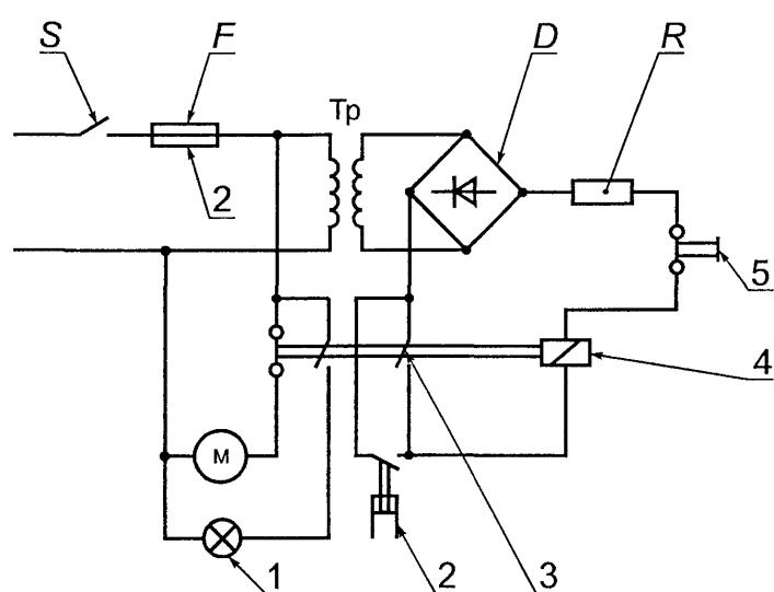
S - выключатель; F - предохранитель;  $T_p$  - трансформатор; D - диодный выпрямительный мост; R - резистор; M - приводной двигатель; 1 - сигнальная лампа; 2 - датчик давления; 3 - удерживающий контакт; 4 - реле; 5 - кнопка сброса
