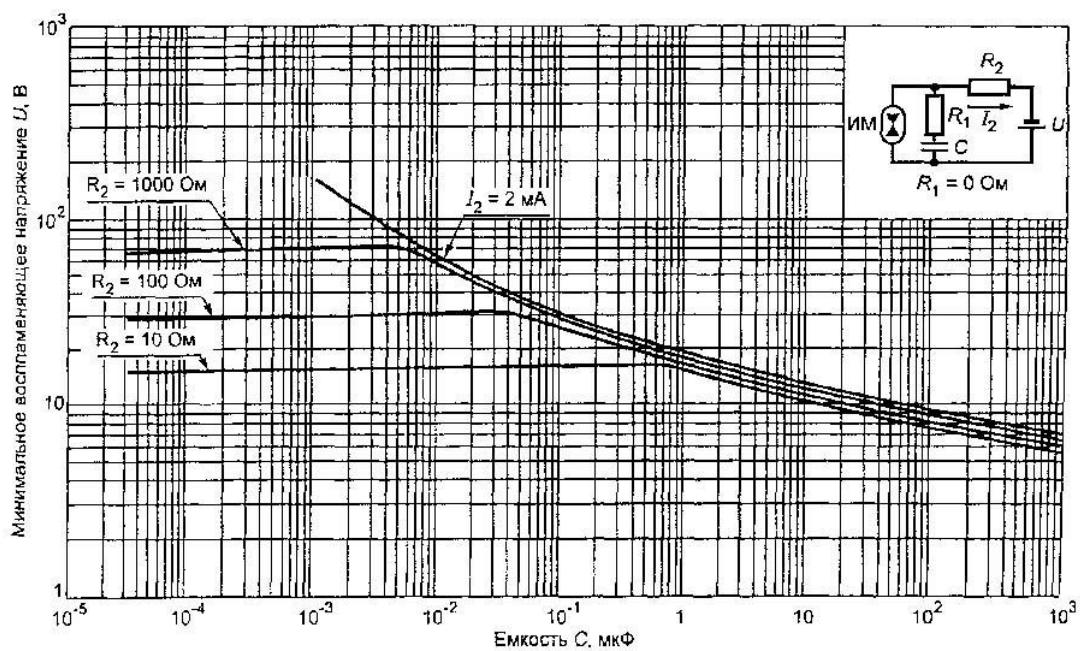
Рисунок А.16. Минимальное воспламеняющее напряжение в активизированной взрывоопасной водородно-кислородной смеси (75 %  $H_2$  + 25 %  $O_2$ ) для емкостных цепей подгруппы ПВ при  $R_1 = 0 \Omega$
