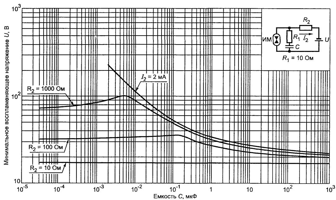
Рисунок A.13. Минимальное воспламеняющее напряжение в активизированной взрывоопасной водородно-кислородной смеси (81 %  $H_2$  + 19 %  $O_2$ ) для емкостных цепей подгруппы PA при  $R_1 = 10 \Omega$
