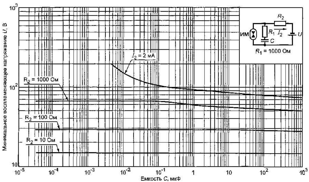
Рисунок А.19. Минимальное воспламеняющее напряжение в активизированной взрывоопасной водородно-кислородной смеси (75 %  $H_2$  + 25 %  $O_2$ ) для емкостных цепей подгруппы ПВ при  $R_1 = 1000 \Omega$
