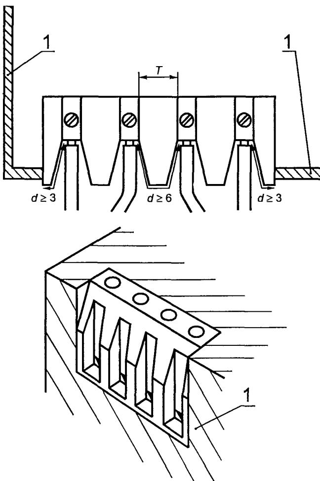
*1* - токопроводящий слой; *T* - зазоры и длина пути утечки в соответствии с таблицей 4;
