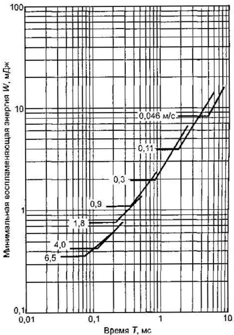
Рисунок A.20. Минимальная воспламеняющая энергия мета-новоздушной смеси (8,3 %  $CH_4$  + 91,7 % воздух) в зависимости от длительности разряда и скорости размыкания контактов цепи для группы I
