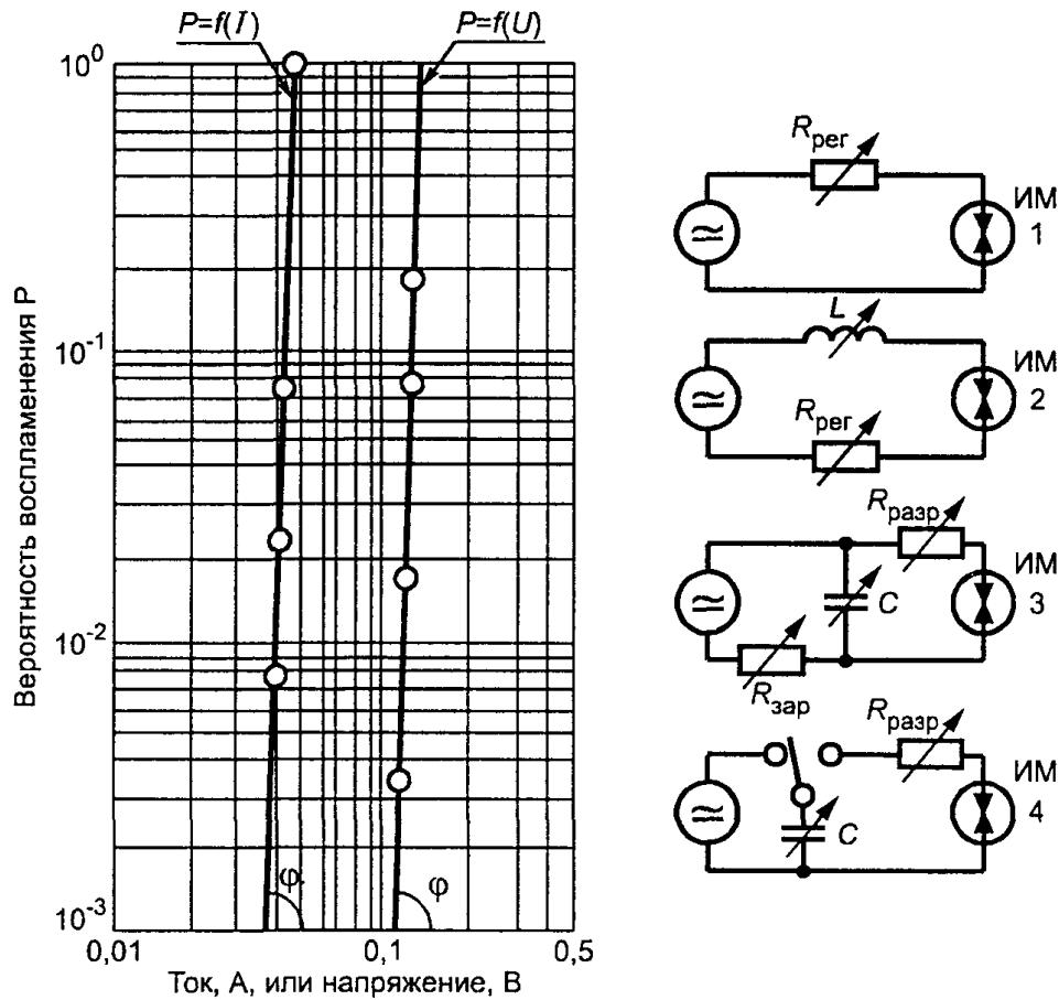
1 - омическая цепь; 2 - индуктивная цепь; 3 - емкостная цепь без отключения емкости;
