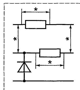
**г) Защита предохранителей в искробезопасной цепи**
