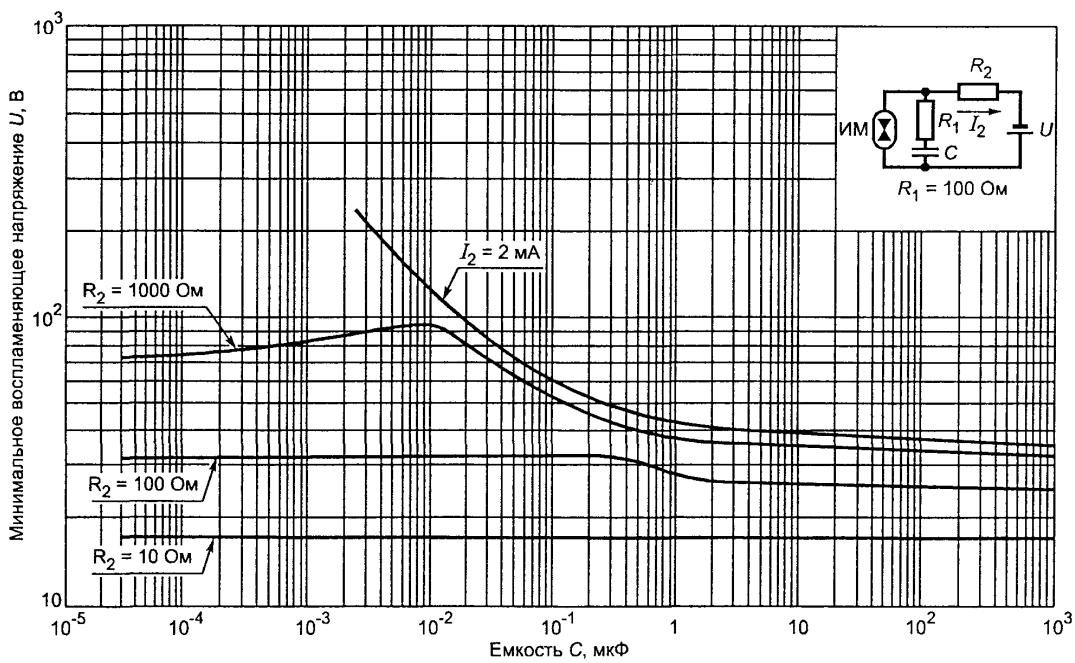
Рисунок А.14. Минимальное воспламеняющее напряжение в активизированной взрывоопасной водородно-кислородной смеси ( $81\% H_2 + 19\% O_2$ ) для емкостных цепей подгруппы IIА при  $R_1 = 100 \Omega$
