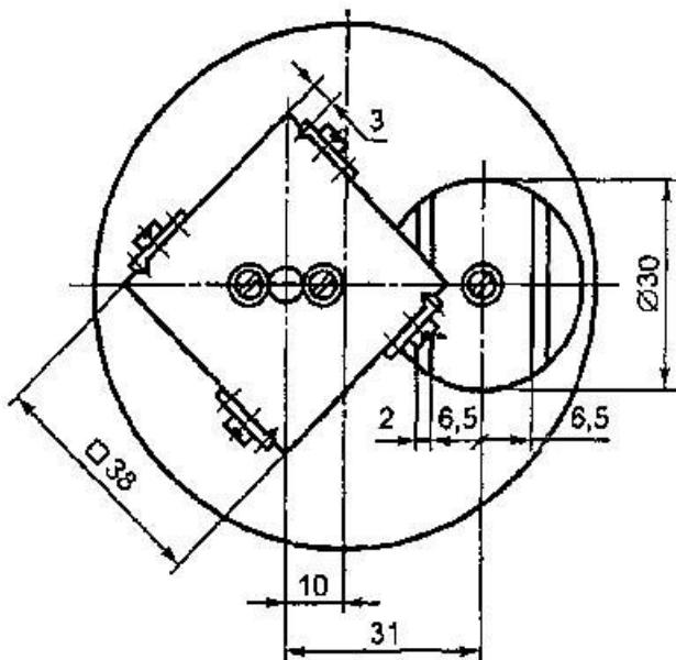
Рисунок Б.1. Кинематическая схема искрообразующего механизма I типа
