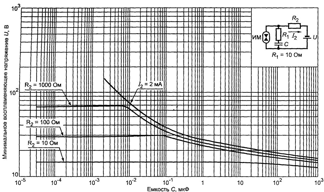
Рисунок А.17. Минимальное воспламеняющее напряжение в активизированной взрывоопасной водородно-кислородной смеси (75 %  $H_2$  + 25 %  $O_2$ ) для емкостных цепей подгруппы ПВ при  $R_1 = 10 \Omega$
