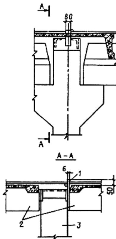
Рис. 24. Узел в системе молниезащиты многоэтажного здания с железобетонными ригелями с полками:
