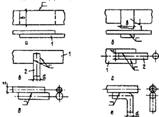
Рис. 7. Соединение заземляющих проводников с горизонтальными заземлителями:
