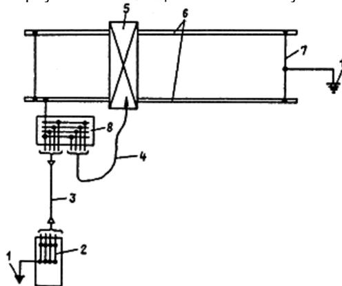
Рис. 18. Схема заземления (зануления) крана, установленного на открытом воздухе и питающегося по гибкому кабелю: 1 - заземлитель; 2 - вторичная обмотка питающего трансформатора; 3 - неподвижный четырехжильный питающий кабель; 4 - гибкий переносной питающих кабель; 5 - кран; 6 - рельсовые путт крана; 7 - перемычка; 8 - вводно-распределительное устройство
