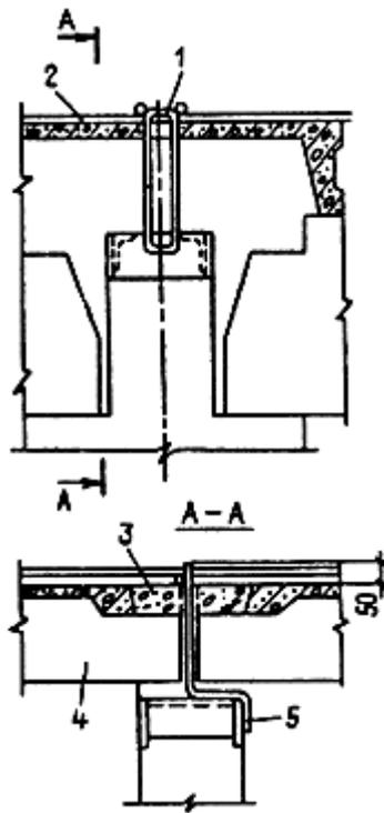
Рис. 23. Узел в системе молниезащиты многоэтажного здания с прямоугольными железобетонными ригелями:
