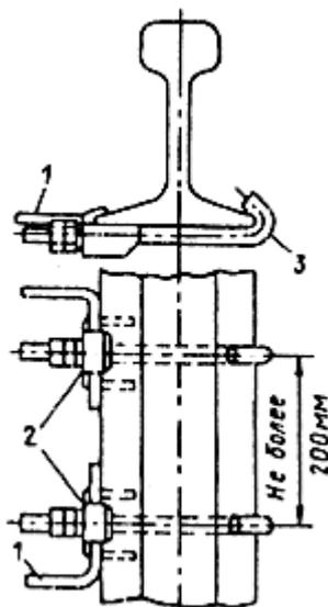
Рис. 3. Присоединение к тяговому рельсу проводников защитного заземления:
