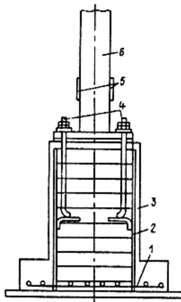
Рис. 2. Соединение металлической колонны с арматурой железобетонного фундамента:
