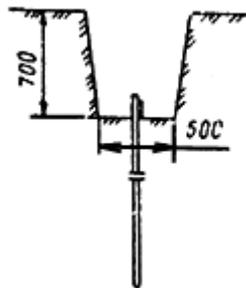
Рис. 4. Установка вертикальных заземлителей
