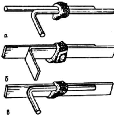
Рис. 10. Ответвления стальных заземляющих проводников, выполненные термитной сваркой
