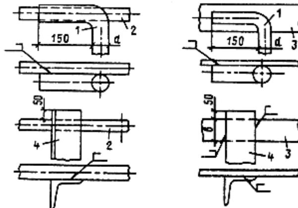
Рис. 6. Соединение заземляющих проводников с вертикальными заземлителями;
