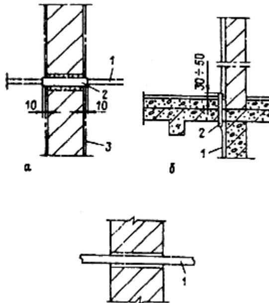
Рис. 13. Проходы заземляющего проводника сквозь стену (а), через перекрытие (б), в открытом проеме (в):
