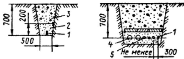
Рис. 5. Прокладка горизонтальных заземлителей в траншее (а) и совместно с кабелем (б):
