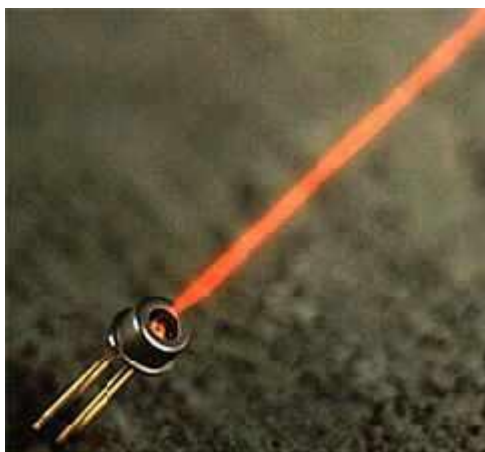
Рис. 3 Лазер поверхностного излучения с вертикальным объемным резонатором (VCSEL)
