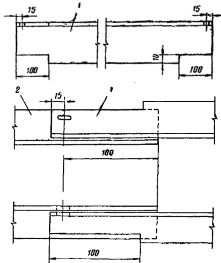
Рис. 5. Подготовка истыковка перед сваркой уголка и перемычки на смонтированном шинопроводе:
