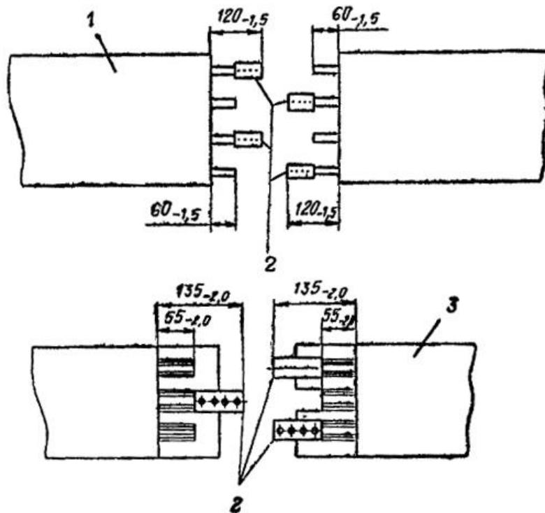
Рис. 30. Расположение шин пристыковке секций троллейного шинопровода:
