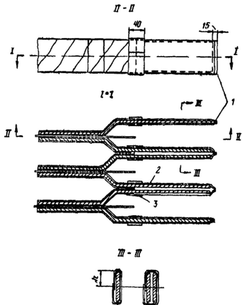
Рис. 12. Концы шин крайней секции, изолированные стеклолакотканью:
