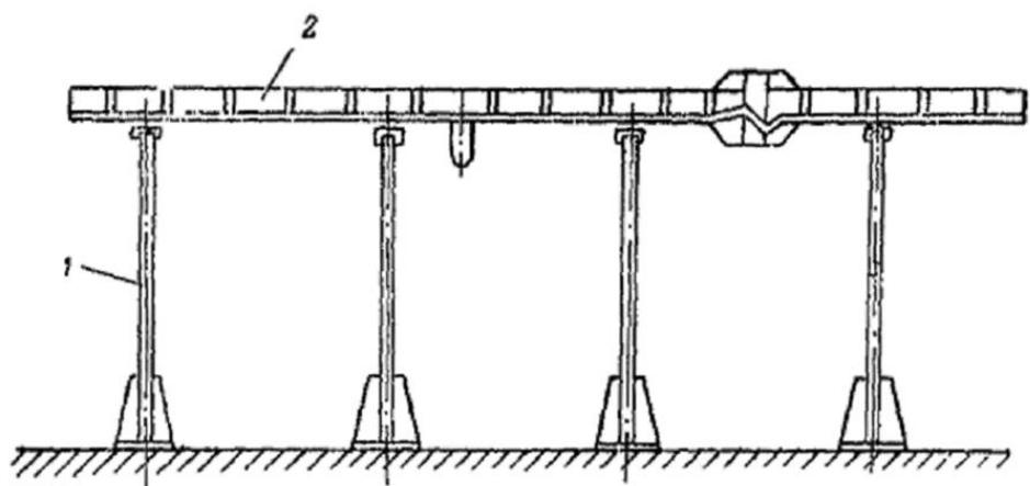
Рис. 18. Прокладка магистрального шинопровода на напольных стойках:
