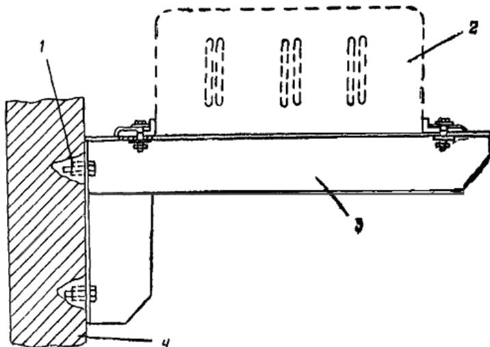
Рис. 13. Прокладка магистрального шинопровода вдоль стены:
