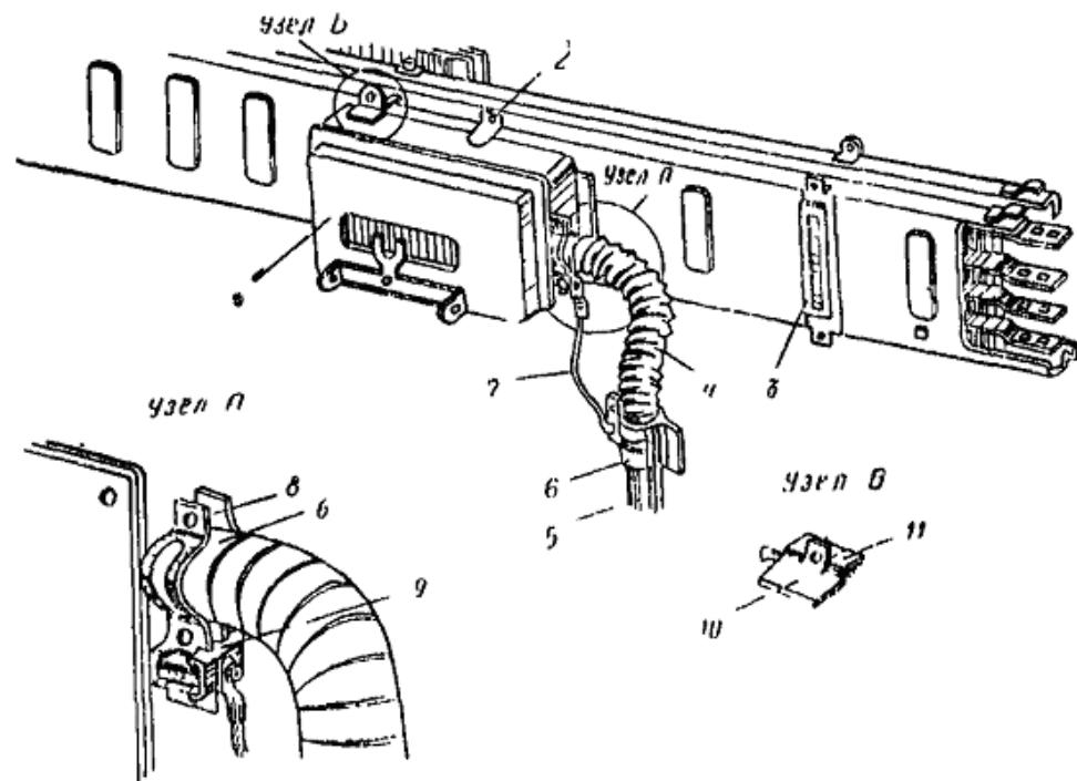
Рис. 36. Установка ответвительной коробки:
