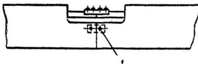
Рис. 31. Установка заземляющей перемычки на троллейном шинопроводе ШТМ-72:
