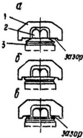
Рис. 28. Контроль затяжки болтового сжима:
