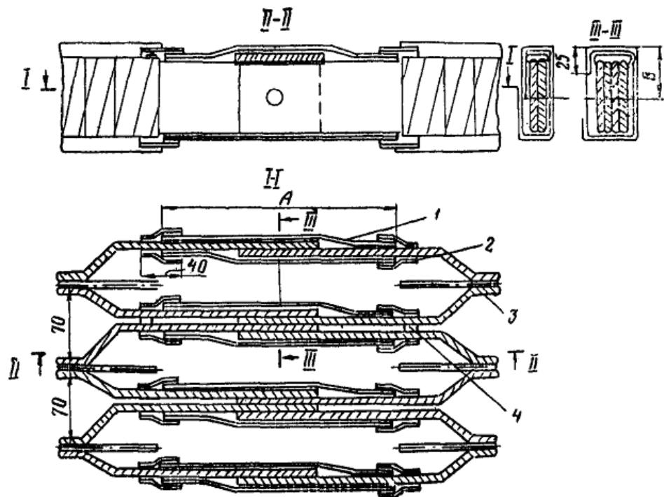
Рис. 10. Сварное соединение прямых секций, изолированное стеклолакотканью:
