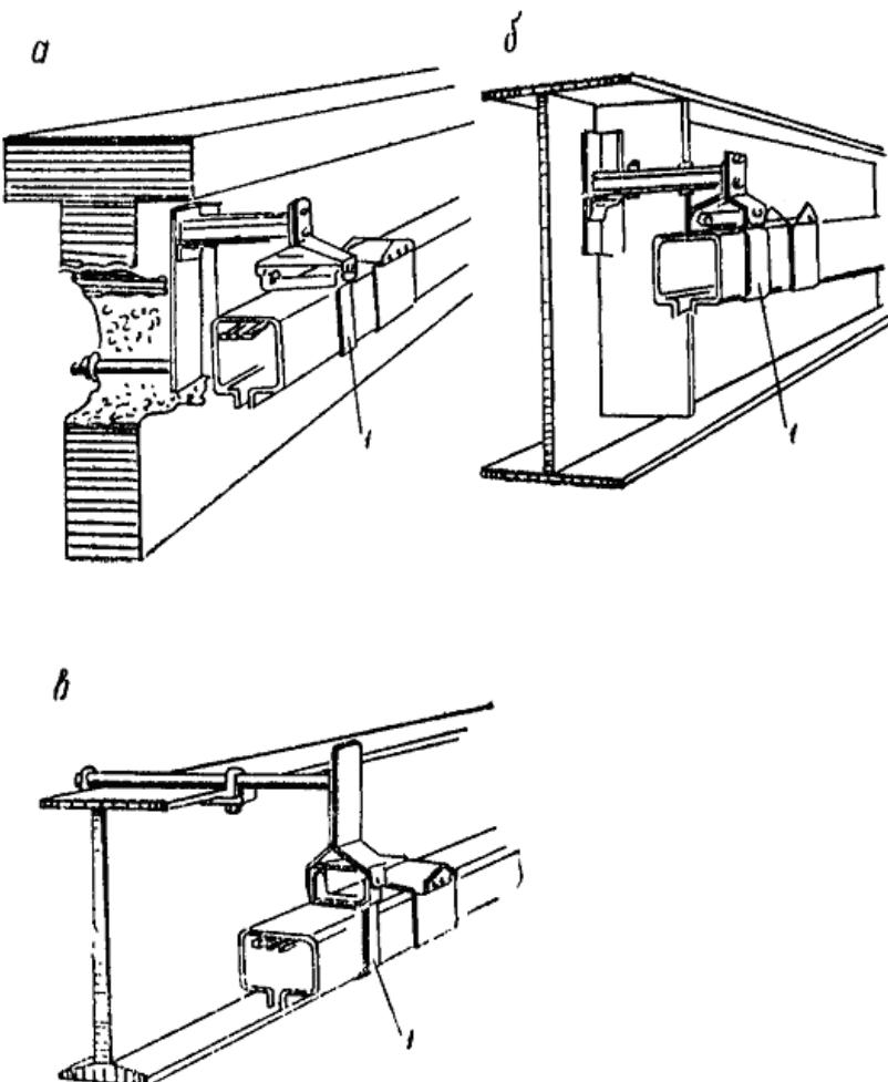
Рис. 39. Варианты крепления тrolleyбусного шинопровода ШТМ72:
