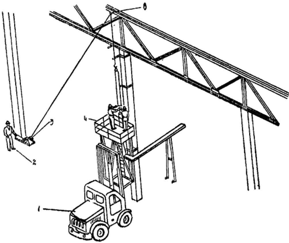
Рис. 23. Монтаж вертикальных участков магистрального шинопровода:
