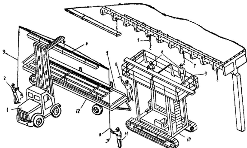
Рис. 20. Монтаж блоков шинопровода с использованием самоходных выдвижных подмостей ПВС-8 (ПВС-12):
