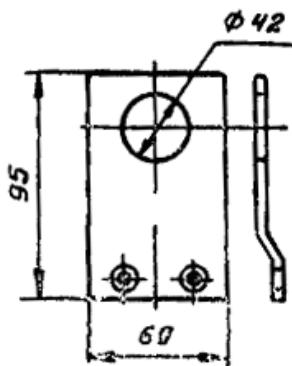
Рис. 25. Перемычка для заземления шпильки болтового сжима
