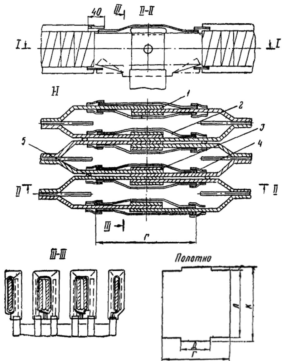
Рис. 11. Сварное соединение секций с ответвлением, изолированное стеклолакотканью:
