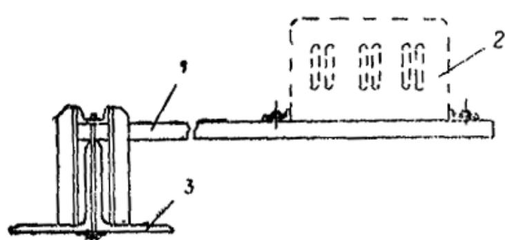
Рис. 16. Прокладка магистрального шинопровода вдоль нижнего пояса металлических ферм:
