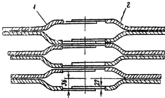
Рис. 2. Расположение шин при соединении секций магистрального шинопровода:
