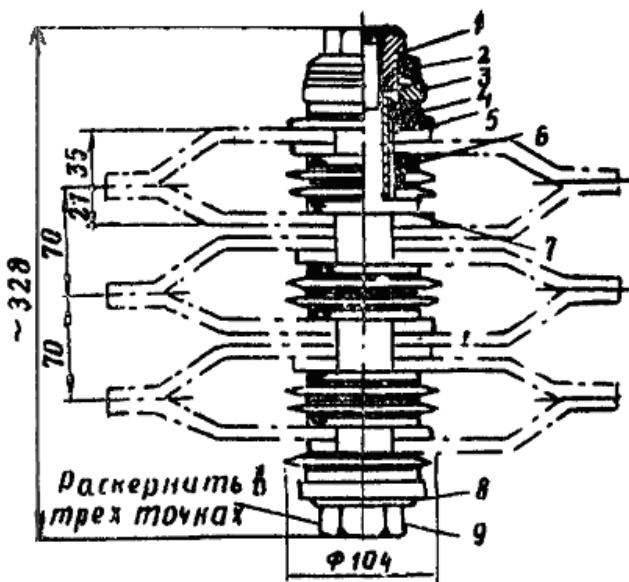
Рис. 24. Болтовой сжим У1535 для шинопровода ШМА68-Н:
