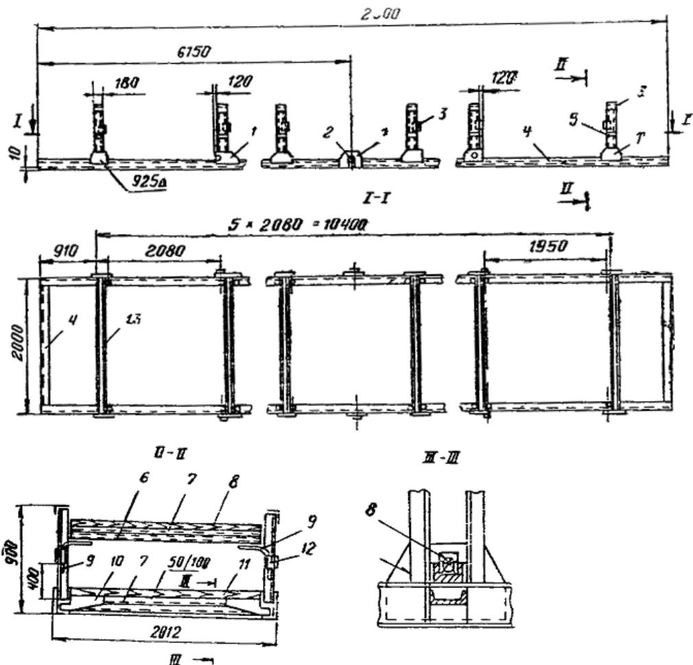
Рис. 1. Контейнер для перевозки секций шинопровода:
