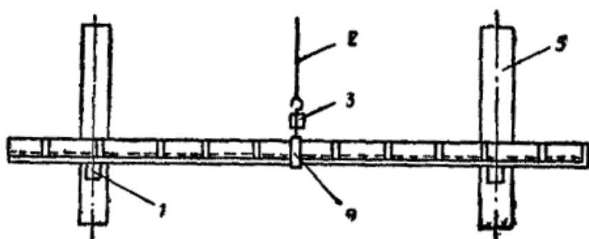
Рис 14. Прокладка магистрального шинопровода вдоль железобетонных колонн:
