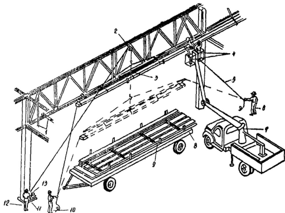
Рис. 19. Монтаж блоков магистрального шинопровода с использованием лебедки:
