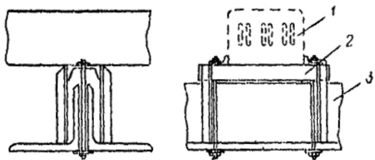
Рис. 17. Прокладка магистрального шинопровода поперек нижнего пояса металлических ферм:
