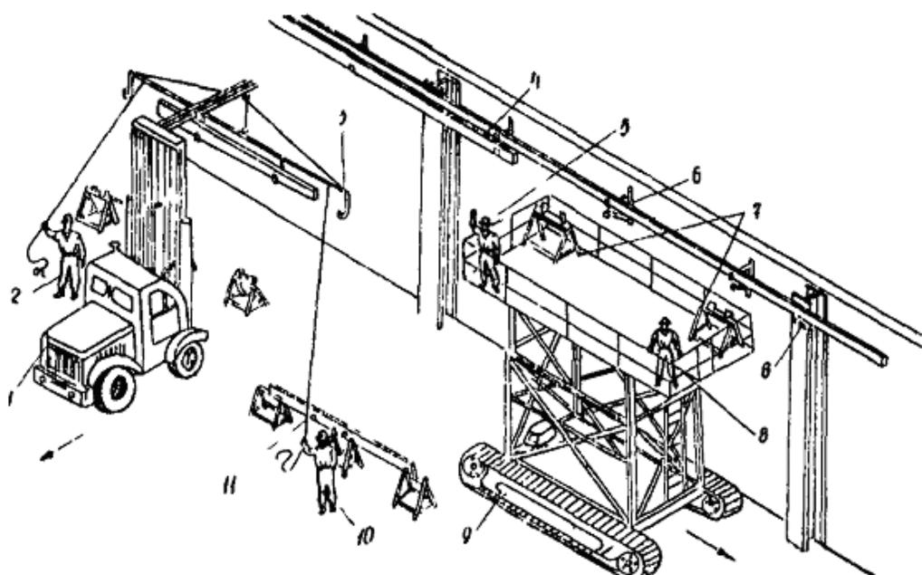
Рис. 33. Монтаж распределительного шинопровода с использованием автопогрузчика самоходных выдвижных подмостей:
