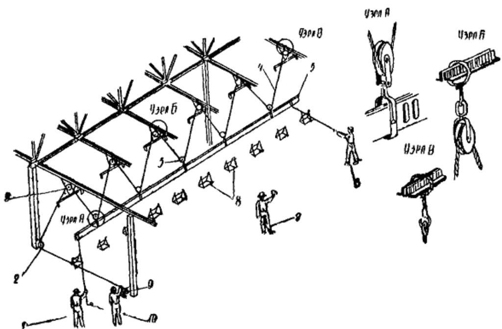
Рис. 34. Монтаж распределительного шинопровода с использованием лебедки:
