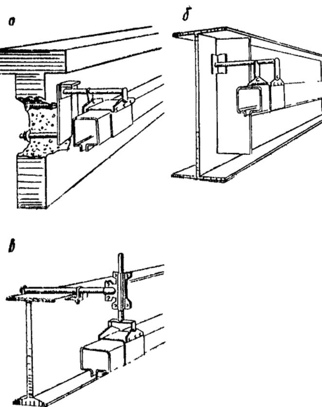
Рис. 37. Варианты установки троллейного шинопровода ШТМ70:
