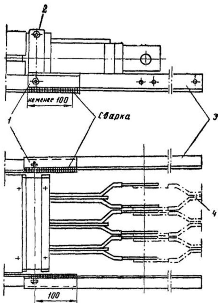
Рис. 6. Сварка опорных уголков шинопроводов серии ШМА:
