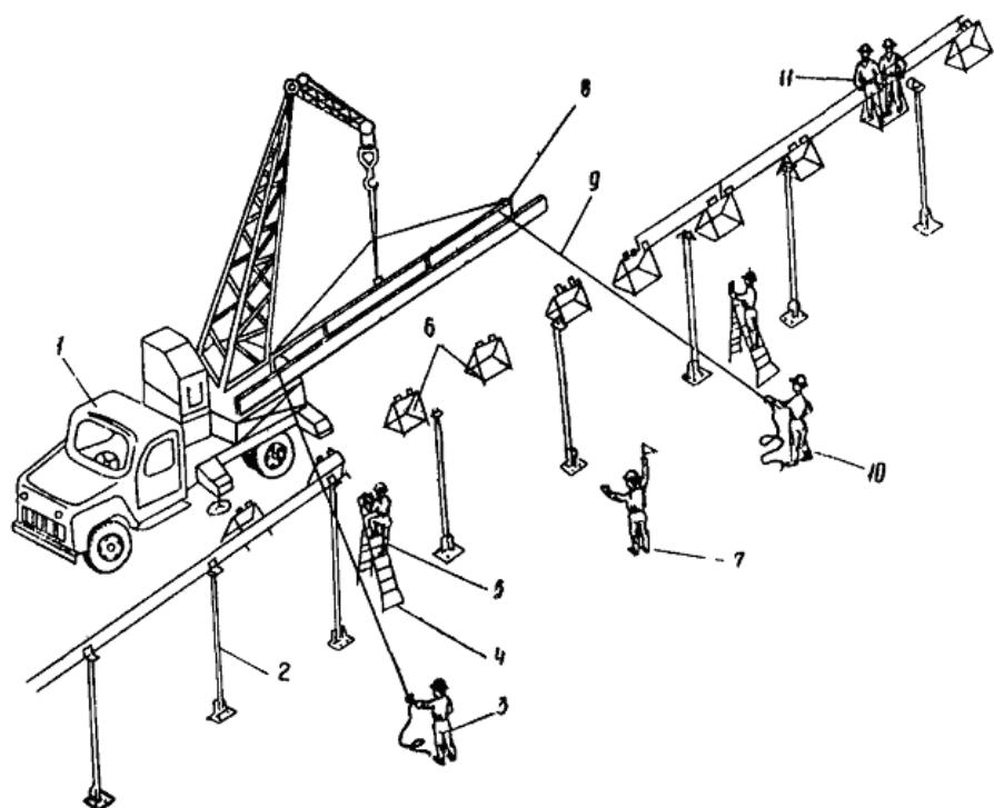
Рис. 32. Монтаж распределительного шинопровода с использованием автокрана:
