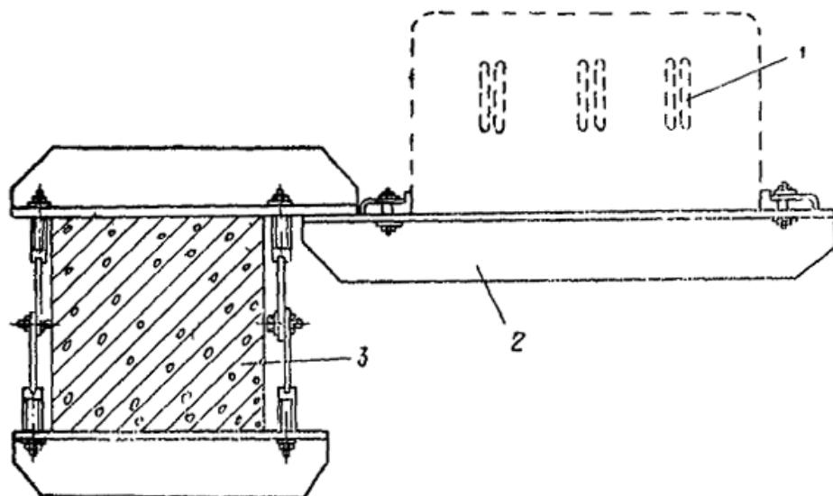
Рис. 15. Прокладка магистрального шинопровода вдоль нижнего пояса железобетонных ферм:
