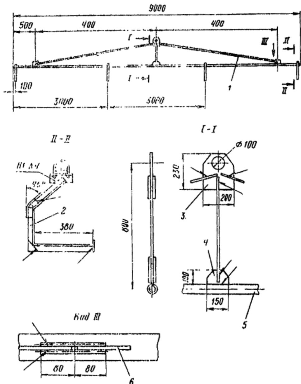
Рис. 2. Траверса для подъема блоков шинопровода:
