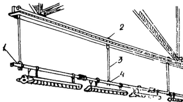
Рис. 41. Шинопровод ШОС67, проложенный на полосовых подвесках вдоль металлических ферм:
